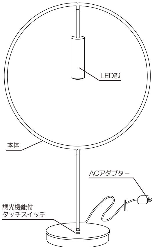
1. プラグをコンセントに差し込み、スイッチで操作する。
