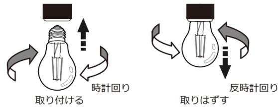
**注意** ランプの交換は、必ず電源を切った状態で行ってください。感電の恐れがあります。また消灯直後は器具が熱くなっており火傷の原因となりますので時間が経ち器具が冷めてからランプの交換を行ってください。
