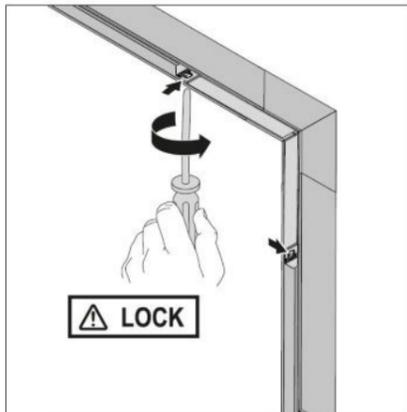
8. 連結する場合は連結用コネクタを取付けて、ロックネジを回してロックさせてください。
