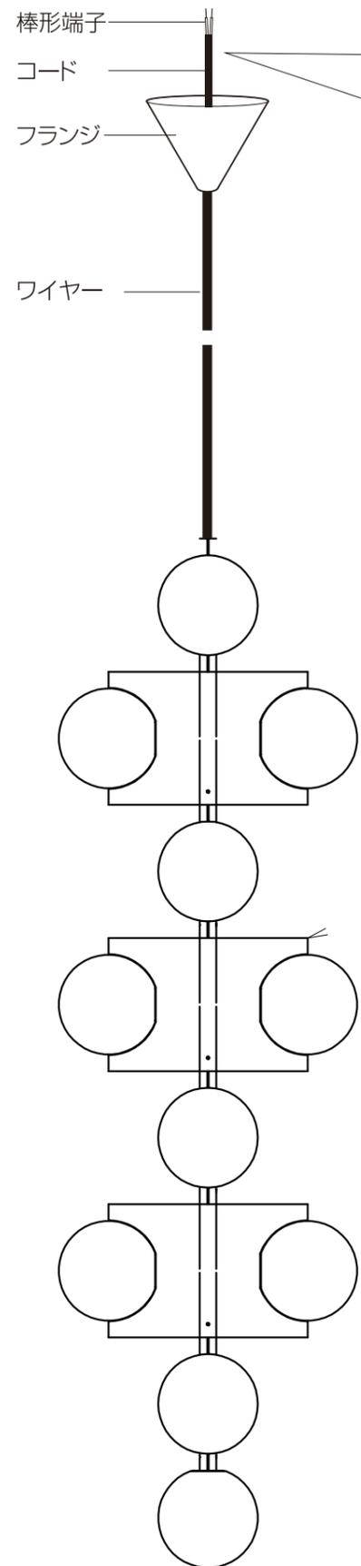
①棒形端子を接続し、フランジを引き上げて固定します。
