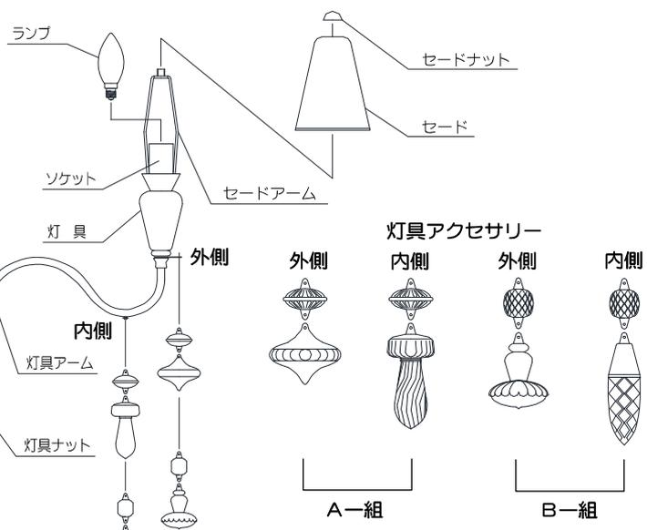
灯具1灯おきにA/B交互に外側と内側のアクセサリを引掛けてお取付ください。(ラジペンなどの工具でピンが外れないようにしっかり閉じてください)
