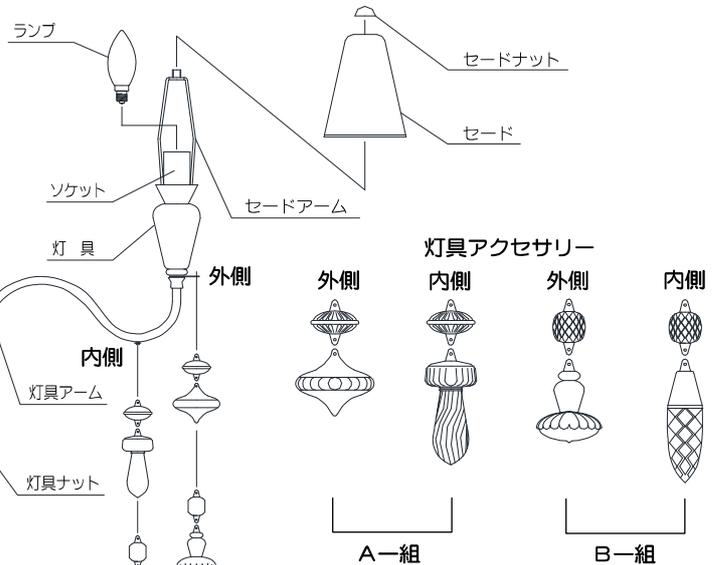
灯具1灯おきにA/B交互に外側と内側のアクセサリを引掛けてお取付ください。(ラジペンなどの工具でピンが外れないようにしっかり閉じてください)
