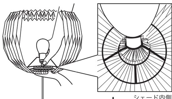
④シェード上面をすばめて持ったまま、シェード内側の折り返し部分を灯具のフレームに引掛けるように固定します。
