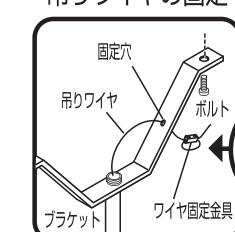
①、②、③、の順に差し込んで強く締めつけ④で二つのビスをお手持ちのドライバーできつく締め付けてください。
