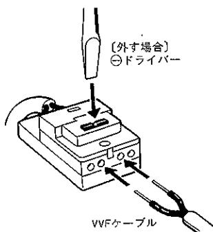
電源電線をストリップゲージに合わせて14mm被覆を剥いでください。矢印の方向に止まるまでぐっと強く差し込んだあと引っ張ってみて抜けないことを確認してください。
