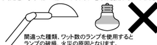
間違った種類、ワット数のランプを使用するとランプの破損、火災の原因となります。
