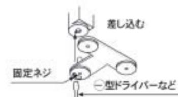
ベースの裏側より固定ネジを差し込み、ドライバー等を用いてベースと本体を固定ネジで締め付け固定してください。
