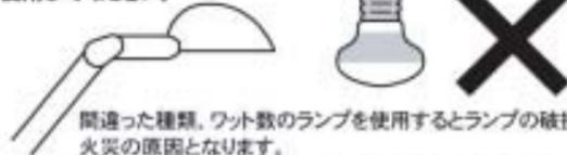
間違った種類、ワット数のランプを使用するとランプの破損、火災の原因となります。
