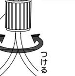
④ キャップを押し上げ、ベースに確実にねじ込む。
