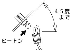
・必ずヒートンの開口部が上を向くように取り付けてください。
