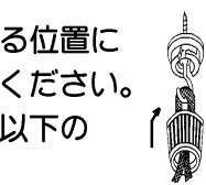
3. コードハンガーを天井の補強材のある位置に取り付けて、器具の高さを調整してください。
