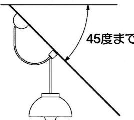
■傾斜天井への取付けは、必ず表記の制限傾斜角度・制限取付方向などをお守りください。器具の落下・破損の原因になります。
