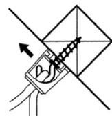
■ 傾斜天井への取付けは、必ず表記の制限傾斜角度・制限取付方向などをお守りください。器具の落下・破損の原因になります。
