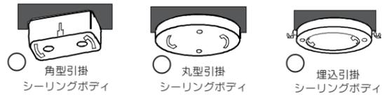
●上図の引掛シーリングボディが付いていない場合は、専門の電気工事店へご依頼ください。引掛シーリングボディ取付電気工事の際は十分な長さの取付ネジ2本で天井の補強材のある位置に取付けてください。
