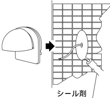
防水用シールで平らに仕上げしてからパッキンを取り付けてください。また、取付面が平らにならない場合は、パッキンを被うように防水用シール剤で防水加工してください。
