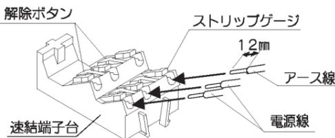
電線をストリップゲージに合わせ、被覆をむいてください。矢印の方向に、止まるまでぐっと差し込んだあと、引っ張ってみて抜けないことを確認してください。外すときは、解除ボタンをドライバー等で押込んで外してください。
