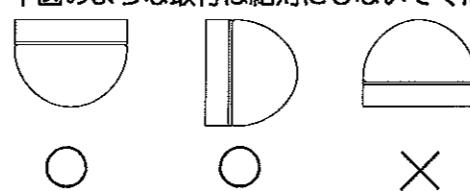
2. 器具に表示してある「取付方向指示シール」の通り正しい方向で取り付けてください。間違った方向で取り付けますと故障や事故の原因となります。(G1180のみ)
