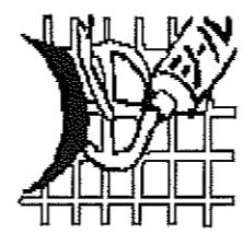
4. 電源電線保護のために、必ず同梱の耐熱チューブを電線にかぶせてください。
