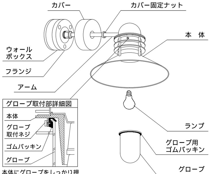
本体にグローブをしっかりと押しさえつけ、3本のグローブ取付ネジを均等に締めつけてグローブを固定してください。
