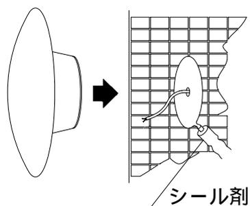
防水用シールで平らに仕上げしてからパッキンを取り付けてください。また、取付面が平らにならない場合は、パッキンを被うように防水用シール剤で防水加工してください。
