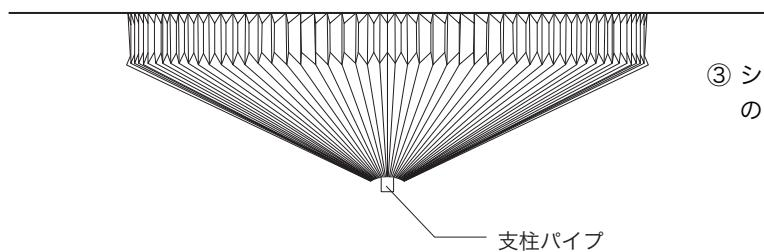
③ シェードを灯具に被せます。その際にシェード先端部の穴から支柱パイプが見える状態にします。
