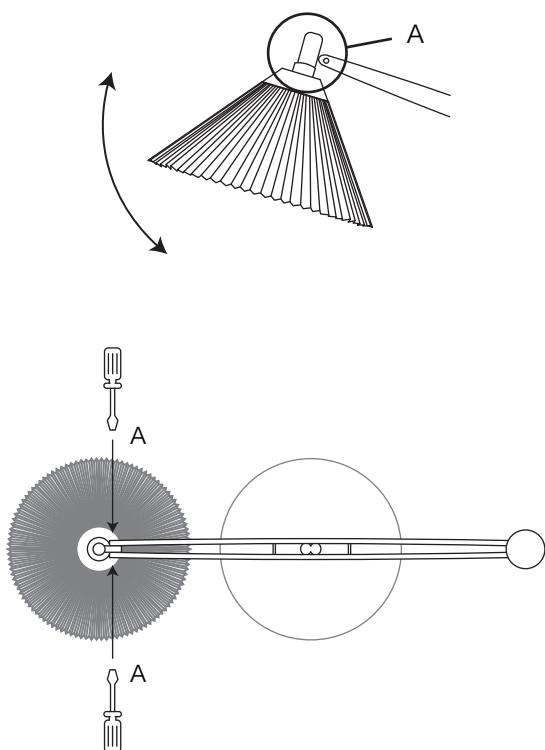
固さを調節したい場合は、以下の手順で調節できます。
