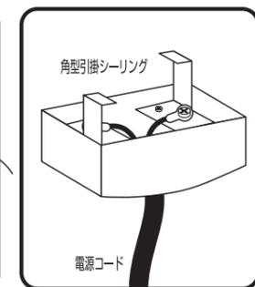
**3** この時点で吊りワイヤをしっかりと固定したブラケットと本体を持って、下からもう一人が保持しブラケットを天井のローゼットに2本のボルトでしっかりと固定してください。このブラケットと吊りワイヤに全ての荷重がかかります。ここでブラケットと吊りワイヤが確実に固定されたことを再度ご確認ください。配線された角型引掛シーリング（オス）を天井のローゼットに差し込み時計回りにねじ込んでください。
