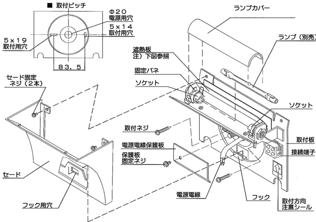
●それぞれ表示してある「取付方向注意シール」の通り正しい方向に取りつけてください。間違った方向に取り付けますと故障や事故の原因になります。
