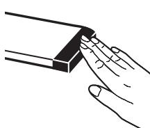
ランプヘッドのタッチエリア(金属部分)にそっと触れてください。内蔵のタッチセンサーにより、触れるたび点灯／消灯が切り替わります。
