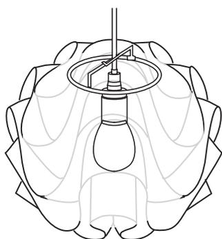
③電球の光源部がシェードの中心に来るようにコードを引き上げ、渡しに付いているクリップでコードを挟み固定します。
