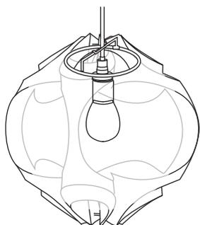
③電球がシェードの中心に来るようにセットし、クリップ付渡しでコードを固定します。
