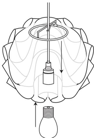
①クリップ付渡しをフレームにセットし、コード（ランプソケット側）をシェード上部から下部へ通します。
