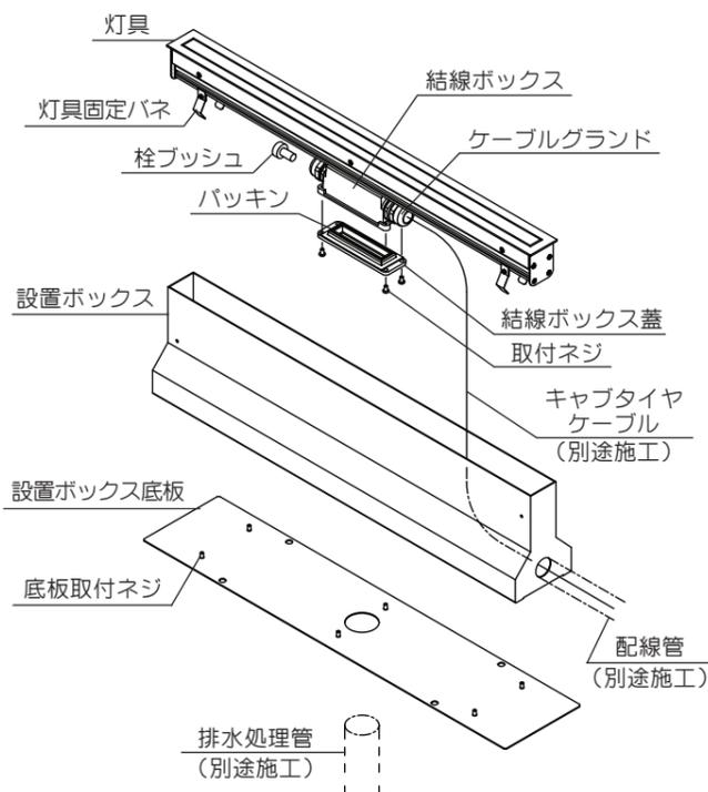
1. 設置ボックス底板をはずして、電線管を設置ボックスに取り付け、電源電線を設置ボディ内に引き込んでください。
