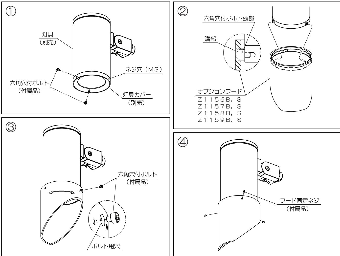
① : 灯具カバー側面のネジ穴 (M3) 3箇所のうちの2箇所に付属の六角穴付ボルトを根元までねじ込んでください。
