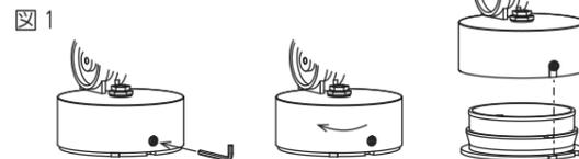
※ 器具を設置する前に図1の通り、六角レンチでフランジ固定ネジをゆるめ、フランジを回転させ、取付板の凸部とフランジ固定ネジ位置を合わせ、取付板とフランジを分離してください。
