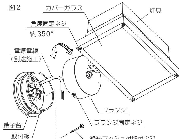
2. 電源電線(別途施工)を電源穴から本体内に引き込み、接続端子に接続してください。(図8)
