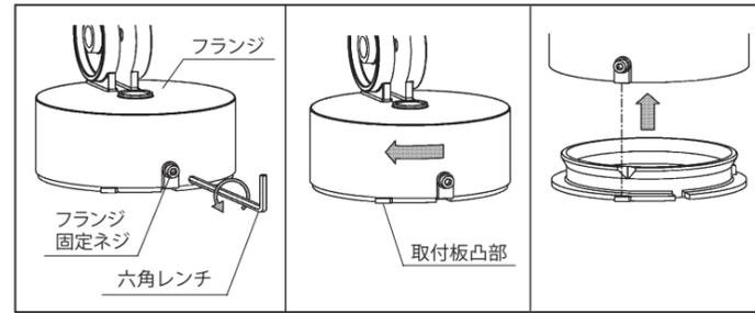
■ 器具を設置する前に図-1の通り、同梱の六角レンチでフランジ固定ネジをゆるめ、フランジを回転させ、取付板の凸部とフランジ固定ネジ位置を合わせ、取付板とフランジを分離してください。その際、接続端子A・Bも分離してください。(図-2)
