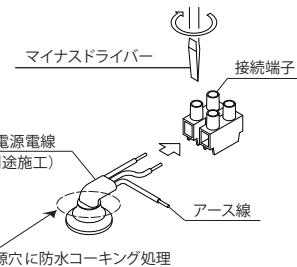
電源線と電源穴に防水コーキング処理
