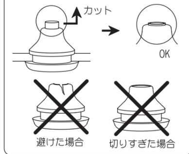
図6 電源線防水処理
