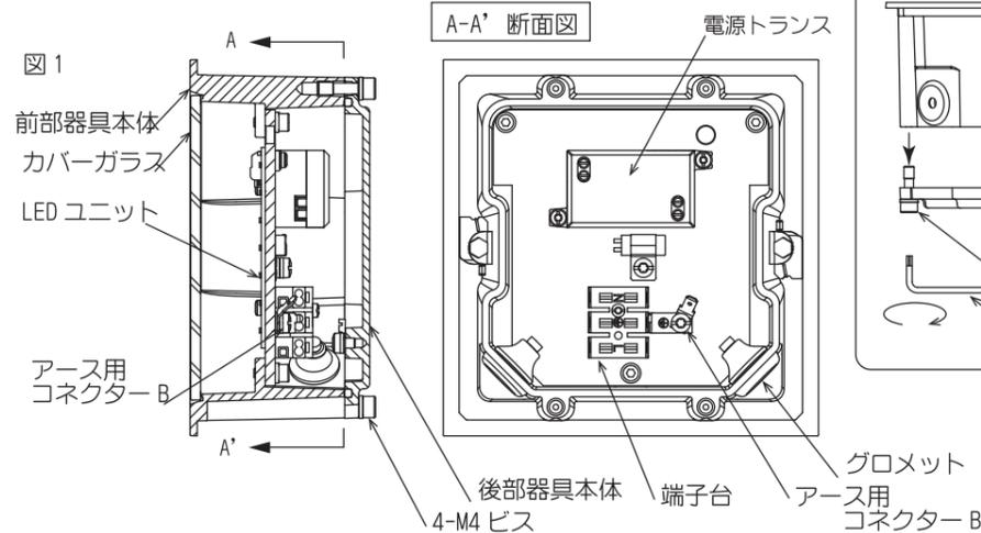
1. 器具を設置する前に背面にある4ヶ所のM4ネジをトルクスレンチで緩めて、前部・後部器具本体を切り離してください。（図2）
