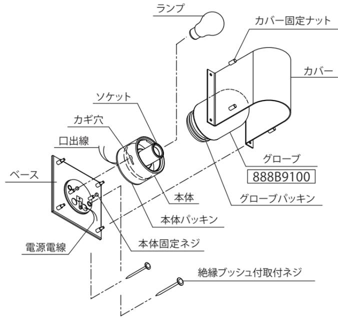
1. 本体固定ネジをゆるめ、右図のようにカギ穴を合わせてベースを本体からはずしてください。
