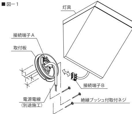
器具を設置する前に図-2のように灯具固定ネジをゆるめ、灯具から取付板を取り外し、接続端子も図-1のように分解してください。
