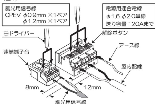
■屋内配線・アース線および調光用信号線の被覆をむいて、矢印の方向に、止まるまでぐっと差し込んだ後、引っ張ってみて抜けないことを確認してください。外すときは、解除ボタンをドライバー等で押し込んで外してください。
