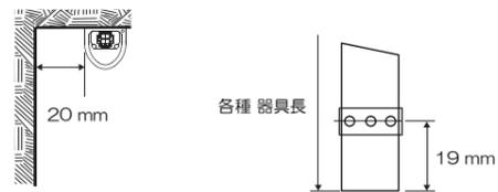
設置寸法（Z1248） 取付寸法（Z1249）
