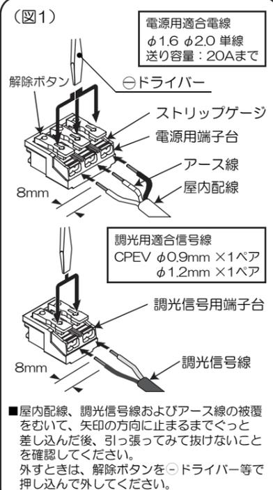
■屋内配線、調光信号線およびアース線の被覆をむいて、矢印の方向に止まるまでぐっと差し込んだ後、引っ張って抜けないことを確認してください。
