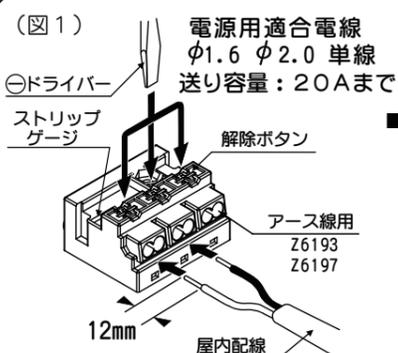
■屋内配線はストリップゲージに合わせて被覆をむいてください。矢印の方向に、止まるまでぐっと差し込んだ後、引っ張ってみて抜けないことを確認してください。外すときは、解除ボタンをドライバー等で押し込んで外してください。
