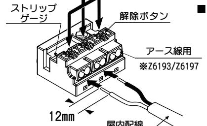
■屋内配線はストリップゲージに合わせて被覆をむいてください。矢印の方向に、止まるまでぐっと差し込んだ後、引っ張ってみて抜かないことを確認してください。外すときは、解除ボタンを $\ominus$ ドライバー等で押し込んで外してください。
