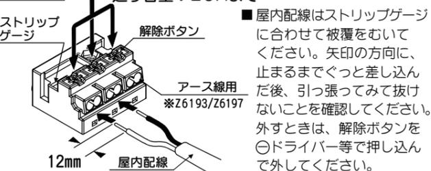
■屋内配線はストリップゲージに合わせて被覆をむいてください。矢印の方向に、止まるまでぐっと差し込んだ後、引っ張ってみて抜けないことを確認してください。外すときは、解除ボタンをドライバー等で押し込んで外してください。
