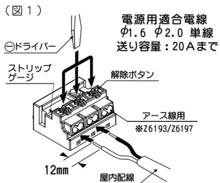
■屋内配線はストリップゲージに合わせて被覆をむいてください。矢印の方向に、止まるまでぐっと差し込んだ後、引っ張ってみて抜けないことを確認してください。
