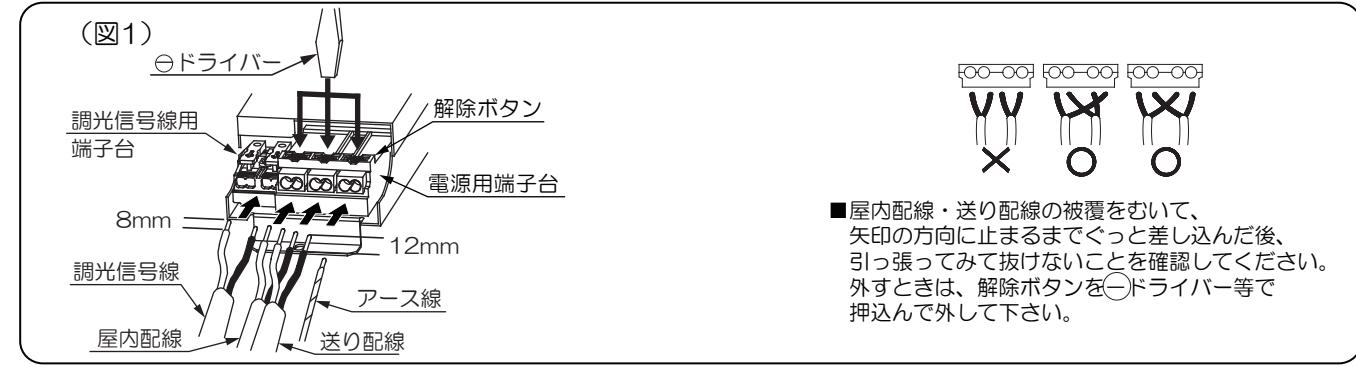
■屋内配線・送り配線の被覆をむいて、矢印の方向に止まるまでぐっと差し込んだ後、引っ張ってみて抜けないことを確認してください。外すときは、解除ボタンをドライバー等で押込んで外して下さい。
