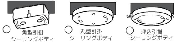
●上図のシーリングボディが付いていない場合は、専門の電気工事店へご依頼ください。引掛シーリングボディ取付電気工事の際は十分な長さの取付ネジ2本で天井の補強材のある位置に取り付けてください。
