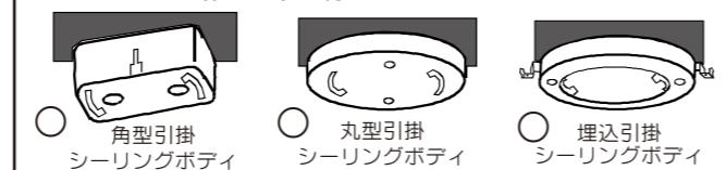
●上図の引掛シーリングボディが付いていない場合は、専門の電気工事店へ引掛シーリングボディ取付電気工事をご依頼ください。電気工事の際は十分な長さの取付ネジ2本で天井の補強材のある位置に取付けてください。
