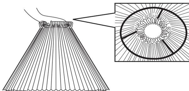
④ゆっくりと手を離せば、シェードの折り返し部分がフレームのリングに引っ掛かり固定されます。
