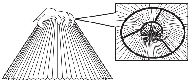
③シェード上面をすばめて持ったまま、シェード内側の折り返し部分を灯具のフレームに引掛けるように固定します。
