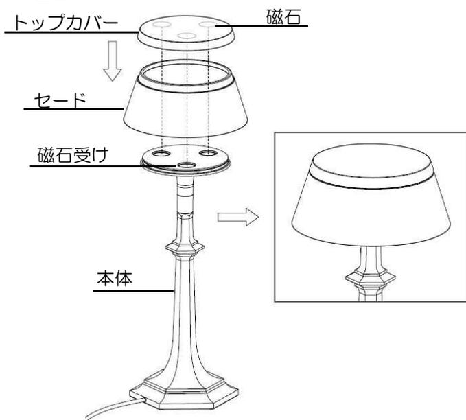
3. セードを本体に乗せて、本体の磁石受けとトップカバーの磁石の位置を合わせてかかぶせ、本体とセードを固定してください。(図2)
